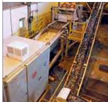
Figuur 18. De volautomatische optische sorteermachine is links onder aanwezig in het afgesloten gedeelte. Een brede loopband is nodig voor deze techniek.
