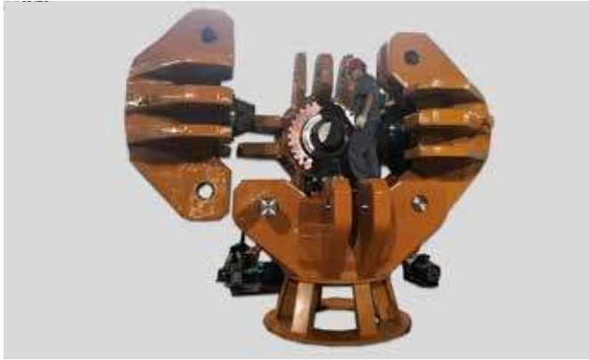
Hogedrukpers waarin HPHT-lab grown diamant wordt geproduceerd (links) en machine voor het maken van CVD-lab grown (foto's: IGI)
