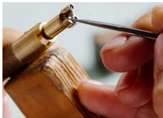
Het hoogglans bruneren van een brug met behulp van een bruneerstaal
